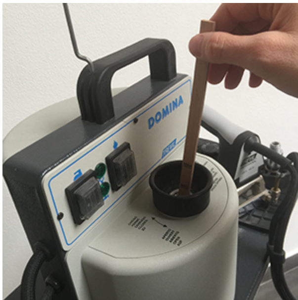
Misuratore del livello dell'acqua
